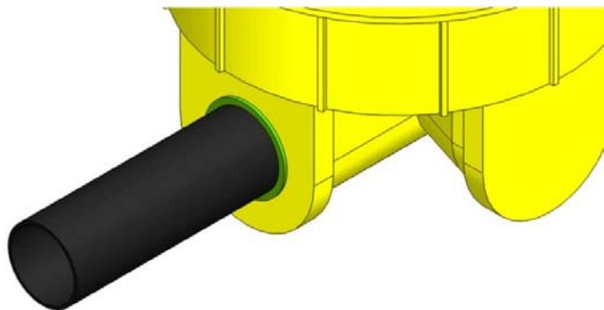
پس از فیکس نمودن منهول پلی اتیلنی و ثابت شدن آن باید لوله های ورودی و خروجی را در محل خود نصب نمود برای اینکار ابتدا باید با مواد روانکار واشر را روغنکاری و سپس لوله مورد نظر را با فشار بداخل آن فرو برد .
