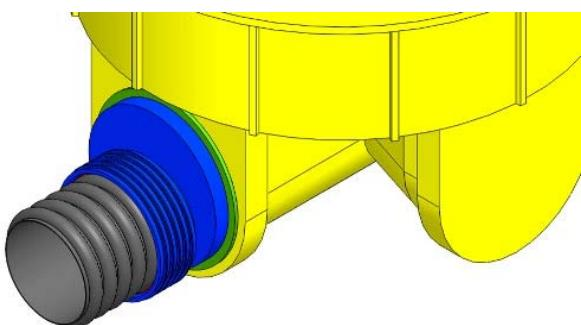
برای رسیدن به شرایط استاندارد در اتصال لوله تجداره پلی اتیلن به منهول پلی اتیلن باید ابتدا
