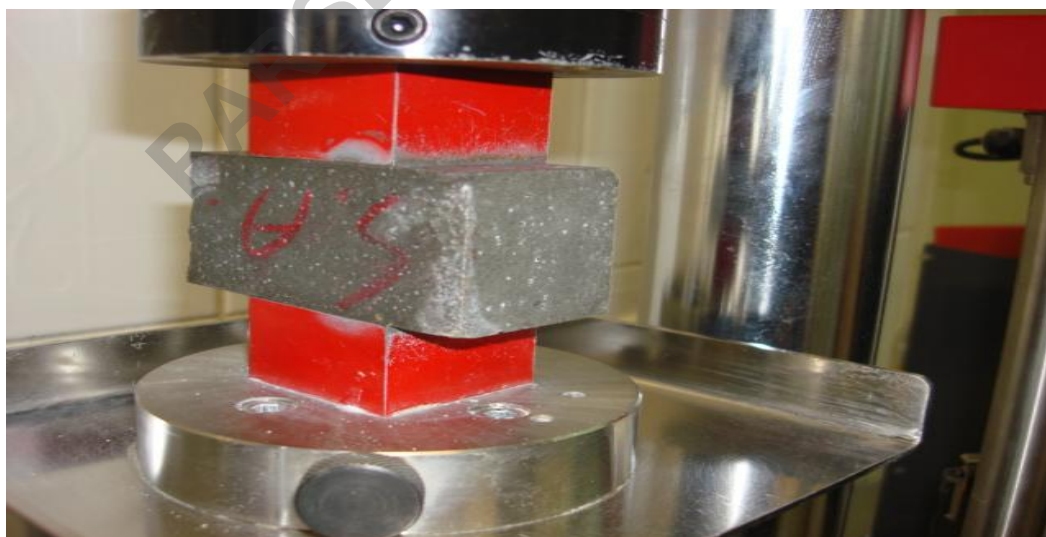
شکل ۴-۲- نمونه تحت بار در دستگاه مقاومت فشاری
