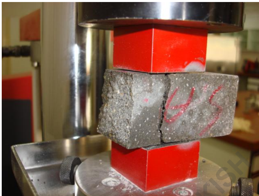
شکل ۴-۷- نمونه تحت بار در دستگاه مقاومت فشاری
