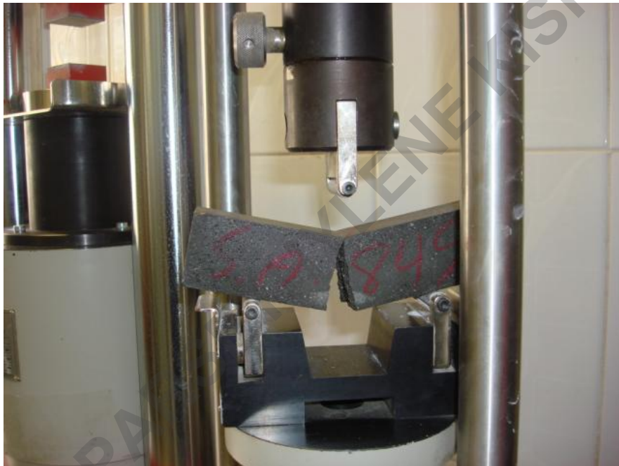
شکل ۴-۵- نمونه تحت بار در دستگاه مقاومت خمشی
