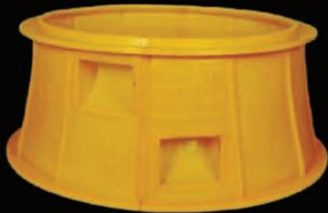
رایزر تبدیلی یا قطعه میانی تبدیلی جبهت افزایش عمق منبول پلی اتیلنی قطر  $110^{\circ}$  میلیمتر به میزان  $5^{\circ}$  سانتیمتر و همزمان تقلیل قطر منبول از  $120^{\circ}$  میلیمتر به  $100^{\circ}$  میلیمتر مورد استفاده قرار می‌گیرد.
