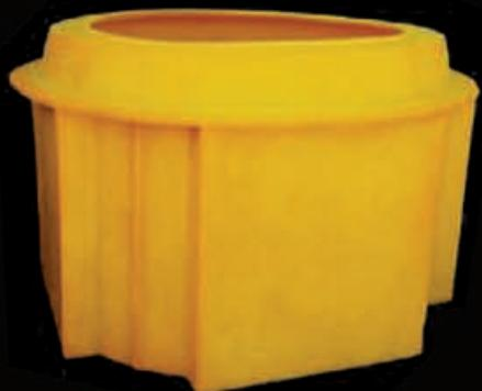
کفی منهول پلی اتیلنی به قطر ۱۳۰۰ میلیمتر به صورت چهار راهی با تبدیل قطر ۱۲۰۰ به ۱۰۰۰ میلیمتر برای سایز لوله ورودی و خروجی سایز لوله حداکثر تا ۵۰۰ میلیمتر.
