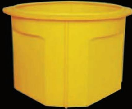
کفی منهول پلی اتیلنی به قطر ۱۰۰۰ میلیمتر به صورت چهاروجهی بدون ماهیچه (Box Type) برای سایز لوله ورودی و خروجی حد اکثر تا ۴۰۰ میلیمتر، مناسب برای شرایطی که اختلاف ارتفاع ورودی و خروجی حد اکثر تا ۲۰ سانتیمتر وجود دارد.
