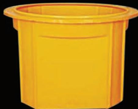
کفی منهول پلی اتیلنی به قطر ۱۰۰۰ میلیمتر به صورت چهاروجهی بدون ماهیچه (Box Type) برای سایز لوله ورودی و خروجی حد اکثر تا ۴۰۰ میلیمتر، مناسب برای شرایطی که اختلاف ارتفاع ورودی و خروجی حد اکثر تا ۳۵ سانتیمتر وجود دارد.
