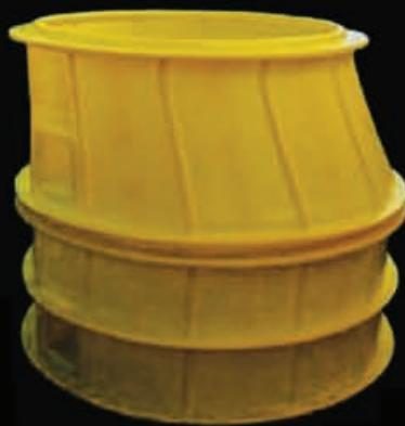
رایزر تبدیلی یا قطعه میانی تبدیلی جبهت افزایش عمق منبول پلی اتیلنی قطر  $110^{\circ}$  میلیمتر به میزان  $1^{\circ}$  سانتیمتر و همزمان تقلیل قطر منبول از  $120^{\circ}$  میلیمتر به  $100^{\circ}$  میلیمتر مورد استفاده قرار می‌گیرد.
