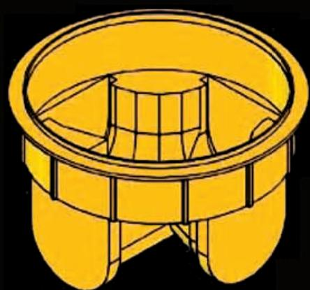
کفی منهول پلی اتیلنی به قطر ۱۰۰۰ میلیمتر به صورت چهار راهی ماهیچه دار (INVERT) با یک ورودی مستقیم، دو ورودی ۹۰ درجه و یک خروجی. حد اکثر تا سایز لوله ۴۰۰ میلیمتر.
